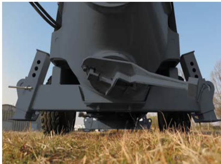
Puerta de descarga para una limpieza óptima de la tolva
